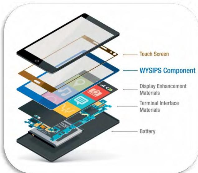
Combinant les technologies optique et photovoltaïque, son principe révolutionnaire est un composant autoproduiteur d'électricité d'origine lumineuse, naturelle et artificielle. Ultrafin et transparent, il s'intègre dans les écrans. Wysips® Crystal optimise tous les types d'appareils : mobiles standards et smartphones, tablette, e-readers, etc. Il s'adapte à toutes les technologies d'écran : MEMMS, bi-stable, LCD, OLED, optical screen, etc.
