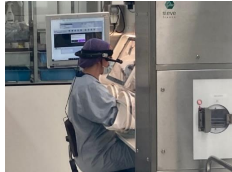
Lunettes de réalité augmentée connectée au logiciel de gestion des préparations anticancéreuses (CHIMIO®)
